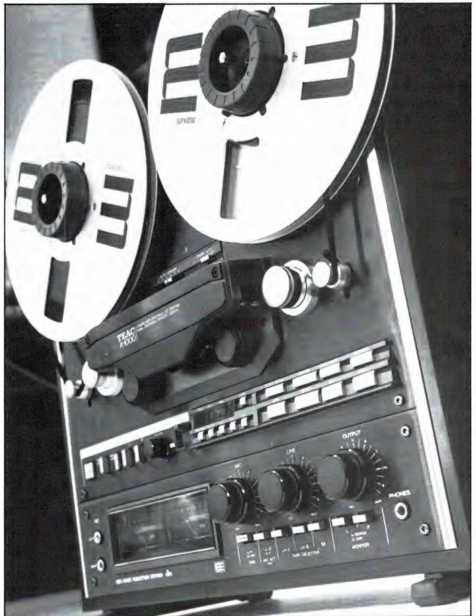
Afb. 11. De voordelen van de spoelenrecorder: hoge bandsnelheid, brede bandsporen (2-spoor kwalitatief te prefereren), geen Dolby nodig, montage-mogelijkheid, robuuste structuur, regelbare echo d.m.v. bandsnelheidsvariatie, lange speelduur.
